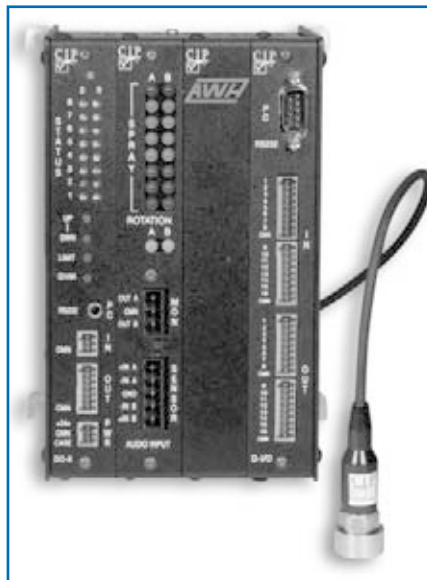
Рис. 1: Датчик CIPMon SC в виде демонтируемой версии для двух измерений с резервным местом для Второго модуля с двумя точками измерения и платой интерфейса
